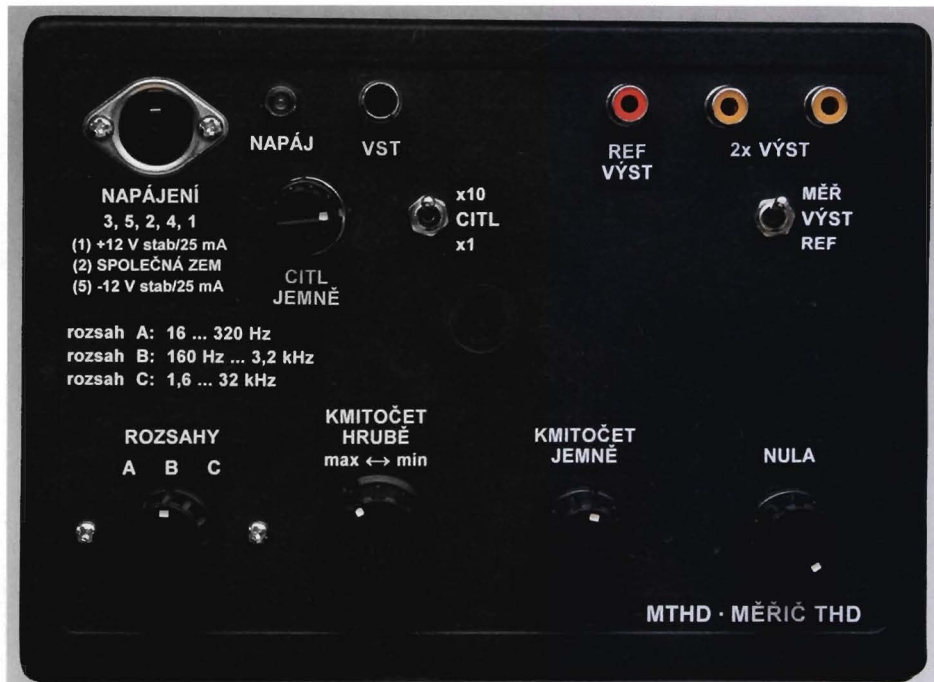
Obr. 9. Pohled na panel měřiče THD
