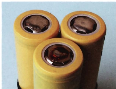
Obr. 3. Pocínování vývodů A123 1100 mAh s použitím kalafuny nebo pájecí kapaliny na nikl
