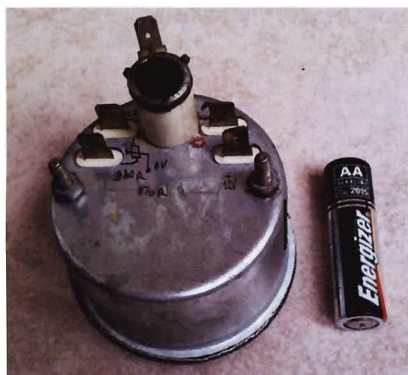
Obr. 33. Palivoměr - poměrový elektromagnetický systém
