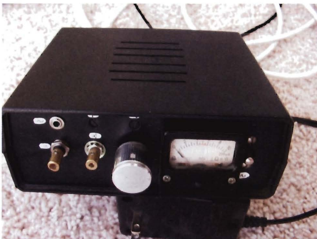
Obr. 16. Dickeho radiometr – pohled na přední panel
