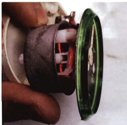
Obr. 34. Vnitřní provedení palivoměru – dvě pevné cívky uvnitř měřidla
