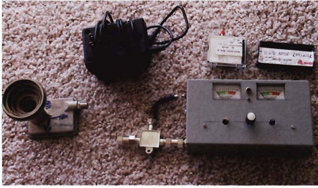
Obr. 12. Součásti polarimetru RPL-11: LNB, napájecí zdroj, skříňka obsahující vše z obr. 9. Pro seřizování se s výhodou použil šumový zářič s modulovaným zdrojem (dvě krabičky nahoře)
